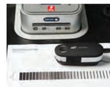
Le spectrophotomètre ES-2000 permet d'étalonner l'imprimante et d'obtenir ainsi des dégradés plus fluides et homogènes, ainsi que des impressions plus uniformes au sein d'un même tirage et sur plusieurs moteurs d'impression.
